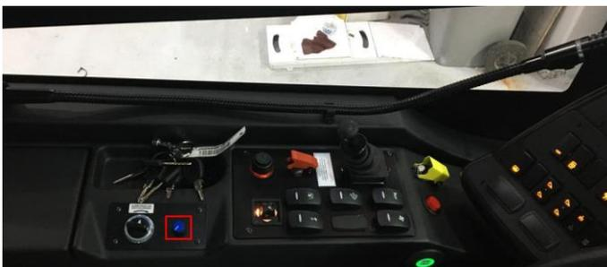
Auf der linken Seite der Treiberkonsole befindet sich ein Mikrofon. Der Ton wird vom Potenziometer, das im Bild rot markiert ist, an- und abgeschaltet.
