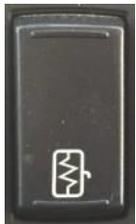
Bei Betätigung des Schalters wird die Außenrückwärme aktiviert. Bei erneuter Betätigung bricht er sofort zusammen; Wenn er nicht gedrückt wird, bricht er nach 500 Sekunden automatisch zusammen. Die Hintergrundbeleuchtung des Schalters leuchtet während der Heizung.
