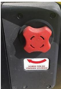
Über der Tür befindet sich auch eine Ein-/Ausschaltsperrung für das Öffnen der Tür, wenn das Fahrzeug von außen mit einem Schlüssel verriegelt wird oder wenn sich Personen im Inneren befinden. Die Steuerung wird bei Bedarf in Richtung des Pfeiles gedreht und die Luft durch Drehen des Luftablasshahns oberhalb der Tür evakuiert, die Tür durch Ziehen nach innen geöffnet.
