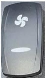
Das Gebläse wird aktiviert, wenn das untere Ende des Schalters gedrückt wird.
