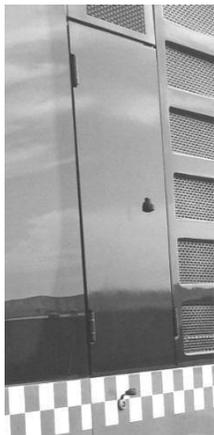
Der Luftfilter, das Ventil zur Heizung, das Ventil und die Pumpe können durch Öffnen der linken Filterkappe erreicht werden.
