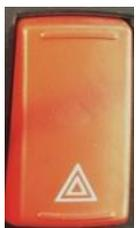
Die Gefahren beginnen zu wirken, wenn sie auf das untere Ende des Schalters gedrückt werden, sie stoppen, wenn sie auf das obere Ende gedrückt werden. Wenn der Schalter betätigt wird, blinken die Signalleuchten an der Anzeigetafel und die Funktionsleuchte am Schalter mit allen Signalleuchten des Fahrzeugs und geben eine akustische Warnung aus.
