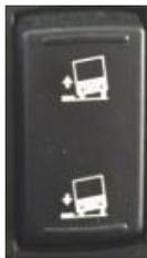
Das Fahrzeug seitwärts kippt nach rechts, wenn es am unteren Ende des Schalters gedrückt wird, und kehrt in die Fahrposition zurück, wenn es am oberen Ende gedrückt wird.
