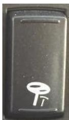
Das Fahrzeug ist mit einem luftunterstützten Einstellsystem ausgestattet, um eine einfache Einstellung zu gewährleisten. Die Lenkradeinstellsperre wird geöffnet, wenn auf den Schalter gedrückt wird, nachdem das Lenkrad durch erneutes Drücken des Schalters verriegelt wurde.
