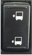
Dieser Schalter wird im Fahrzeug für eine höhere Fahrstufe als normal verwendet. Das Fahrzeug erreicht eine höhere Ebene, wenn es am oberen Ende des Schalters gedrückt wird, und es erreicht eine normale Fahrebene, wenn es am unteren Ende gedrückt wird.
