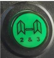
Öffnet oder schließt gleichzeitig die mittlere Tür und die hintere Tür. Die Hintergrundbeleuchtung leuchtet auf, wenn die Tür geöffnet wird, und erlischt, wenn sie geschlossen wird. Bei Geschwindigkeiten von mehr als 5 km wird die Türfreigabe nicht aktiviert.
