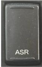
Das ASR-System bricht aus, wenn es am unteren Ende des Schalters gedrückt wird, und das System wird aktiviert, wenn es am oberen Ende gedrückt wird.
