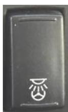
Die Lichter leuchten, wenn sie am unteren Ende des Schalters gedrückt werden, und sind aus, wenn sie am oberen Ende gedrückt werden.
