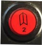
Öffnet oder schließt die mittlere Tür. Die Hintergrundbeleuchtung leuchtet auf, wenn die Tür geöffnet wird, und erlischt, wenn sie geschlossen wird. Bei Geschwindigkeiten von mehr als 5 km wird die Türfreigabe nicht aktiviert.
