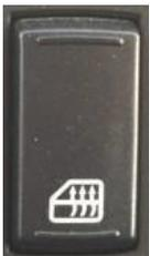
Fahrerseitige Fensterheizung aktiviert, wenn auf den Schalter gedrückt wird. Bei erneuter Betätigung bricht er sofort zusammen; Wenn er nicht gedrückt wird, bricht er nach 500 Sekunden automatisch zusammen. Die Hintergrundbeleuchtung des Schalters leuchtet während der Heizung.
