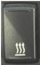
Wenn Sie einmal auf das untere Ende des Schalters drücken, wird die erste Ebene aktiviert. Bei zweimaligem Drücken wird die zweite Ebene aktiviert. wenn es zum dritten Mal gedrückt wird, bricht es zusammen.
