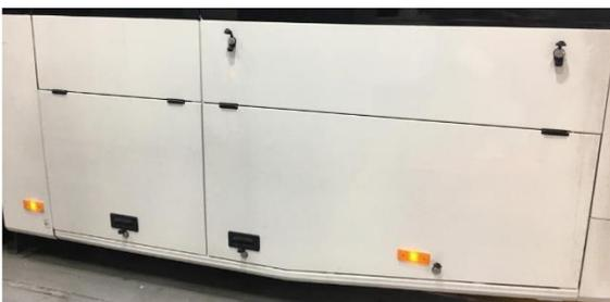
Ölfilter, Kraftstofffilter, Anlasser, Generatoren und Turboeinheit können durch Öffnen der linken unteren Kappe erreicht werden.
