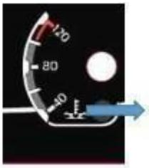
Es zeigt die Temperatur der Motorkühlflüssigkeit. Wenn die Temperatur 107 °C überschreitet, leuchtet die Warnleuchte rot.
