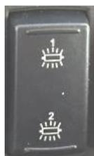
Die Funktionsleuchte leuchtet auf, wenn der Schalter betätigt wird. Der Schalter hat 3 Positionen.
