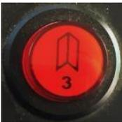
Öffnet oder schließt die Hintertür. Die Hintergrundbeleuchtung leuchtet auf, wenn die Tür geöffnet wird, und erlischt, wenn sie geschlossen wird. Bei Geschwindigkeiten von mehr als 5 km wird die Türfreigabe nicht aktiviert.
