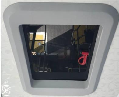
Es gibt 2 Falltüren inklusive Vorder- und Rückseite im Fahrzeug. Sie werden elektrisch gesteuert. Die Eröffnung/ Schließung Vorgänge von die Abdeckungen entsprechend der gewünschten Richtung des Lufteinlasses werden mit dem Luftzustandsschalter am vorderen Bedienfeld realisiert. Falltüren sind so konzipiert, dass sie bei Bedarf als Notausgänge verwendet werden können.
