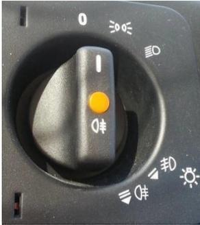
Wenn er sich in der Position "0" befindet und einmal nach rechts gedreht wird, leuchten die Parkleuchten, wenn er noch einmal gedreht wird, die Scheinwerfer. Wenn der Schalter hochgezogen wird, während die Parkleuchten oder Scheinwerfer eingeschaltet waren, leuchten die Nebelscheinwerfer auf; Wenn er noch einmal hochgezogen wird, leuchten die Nebelschlussleuchten.
