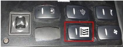
Wenn die Schaltfläche aktiviert ist; Die Standheizung arbeitet automatisch nach der Außentemperatur. Bei Außentemperaturen unter 5 °C wird der Vorwärmer eingeschaltet. Diese Taste muss ausgeschaltet werden, um die automatische Standheizung auszuschalten.
