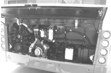
Es kann zu Generatoren, Klimaanlage Kompressor, Keilriemen, Umwälzpumpe, Kraftstoff Wasserabscheider, der Öltank von Motoröl ergänzen, Diesel-Abgas-Fluid-Tank, ECM (Electric Control Module), Steuerknüppel, Lenktank, Dosierpumpe und Dosierpumpe Luftfilter durch Öffnen der hinteren unteren Kappe erreicht werden.
