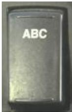
Die Weganzeige wird aktiviert, wenn sie am oberen Ende des Schalters gedrückt wird, und bricht ab, wenn sie am unteren Ende gedrückt wird.
