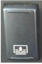
Es dient zum Öffnen und Schließen des Vorhangs vor dem Fahrer. Wenn er auf das untere Ende des Schalters gedrückt wird, fällt der Vorhang. Wenn der Schalter losgelassen wird, stoppt die Bewegung des Vorhangs und bleibt in dem Niveau, in dem er abgesenkt wurde. Wenn er auf das obere Ende des Schalters gedrückt wird, bewegt sich der Vorhang stromaufwärts.
