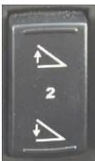
Beim Drücken auf das obere Ende des Schalters wird die hintere Dachentlüftung geöffnet. Er wird geschlossen, wenn er auf das untere Ende des Schalters gedrückt wird. Die Hintergrundbeleuchtung blinkt während der Auf- und Abbewegung der Dachentlüftung. Die Hintergrundbeleuchtung leuchtet beim Öffnen der Dachentlüftung. Die Dachentlüftung wird automatisch geschlossen, wenn Heizung, Klimaanlage oder Wischer in Betrieb waren.
