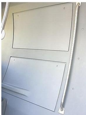
Durch Öffnen von 2 Kappen innerhalb des Fahrzeugs ist es zu Luftkompressor, Hydraulikventilator, Lenkpumpe, Kraftstofffilter, Kraftstoffpumpe, Wärme- und NOX-Sensor an der Abgasbehandlungsanlage, Harnstoffinjektor, Ventildeckel, Motoröleinfüllrohr, Getriebeölfüllung und Füllstandsmesskragen zu erreichen.
