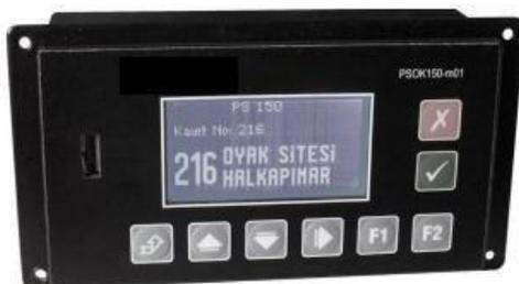
An der oberen Konsole im Fahrerraum befindet sich ein Bedienfeld für die Routenanzeige. Routeninformationen, die in der Routenanzeige angezeigt würden, werden von diesem Bedienfeld ausgewählt/geändert.
