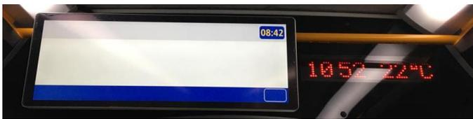
Es gibt ein 19" LCD-Display an der Vorderseite des Fahrzeugs. Dieser Bildschirm kann zur Information der Passagiere und für Anzeigeneindrücke verwendet werden..
