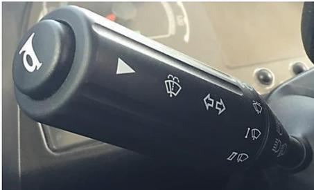
Er signalisiert nach links, wenn sich der Hebel stromabwärts befindet, und nach rechts, wenn sich der Hebel stromaufwärts befindet. Sie aktiviert die Wischer in der ersten Windung intermittierend, in der zweiten Windung mit Normalgeschwindigkeit und in der dritten Windung mit hoher Geschwindigkeit. Der Brunnen beginnt zu arbeiten, wenn er auf das Lenkrad zu gedrückt wird. Das Horn wird aktiviert, wenn man auf den Knopf an seinem Ende drückt.
