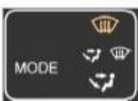
Die Taste für die Richtung des Luftstroms des Fahrers regelt die Position der vorderen Heizluftklappe. Die Positionen sind Mitte-, Mix- und Fußbrunnenbelüftung. Die aktive Position wird mit gelbem Licht beleuchtet.
