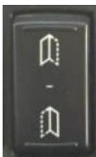
Beim Drücken auf das obere Ende des Schalters der linke Flügel, beim Drücken auf das untere Ende der rechte Flügel, wenn in der Mitte beide Flügel der Haustür offen und geschlossen geblieben.
