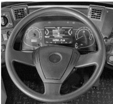
Das Lenkrad kann je nach Fahrkomfort des Fahrers nach oben, unten, vorne und hinten verstellt werden. Für diese Einstellung wird der Niveauschalter des Lenkrades am vorderen Bedienfeld verwendet. Bei der Einstellung muss genügend Luftdruck im Fahrzeug vorhanden sein.
