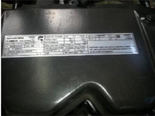
Auf dem Motorkennzeichen auf der Zylinderkopfhaube.
