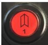
Gemäß der Bestimmung mit Schalter, die die Betriebsart der Fronttür bestimmt, öffnet oder schließt die Fronttür links, rechts oder beide Flügel. Die Hintergrundbeleuchtung leuchtet auf, wenn die Tür geöffnet wird, und erlischt, wenn sie geschlossen wird. Bei Geschwindigkeiten von mehr als 5 km wird die Türfreigabe nicht aktiviert.
