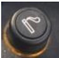
Das Feuerzeug wird in Richtung des Heizelements in ihm geschoben, es wird automatisch beim Erwärmen ausgestoßen.
