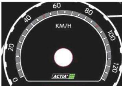
Es ist der Indikator, der die Geschwindigkeit des Fahrzeugs in Kilometern/Stunde anzeigt. Es beginnt zu arbeiten, nachdem das Fahrzeug bewegt wurde.
