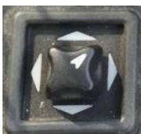
Dieser Schalter dient dazu, dass der Fahrer die Richtungen der Rückspiegel selbst einstellt. Der Spiegel wird in die gewünschte Richtung gedreht, indem der Pfeil am Schalter in die gewünschte Richtung gedreht wird und der Schalter (rechts, links, oben, unten) gelenkt wird.
