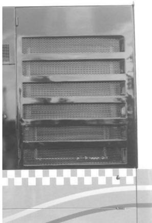
Kühlgerät, Ausdehnungsgefäß-Wassereinfüllstutzen und Niveauüberwachungsfenster können durch Öffnen der linken Kühlerkappe erreicht werden.
