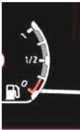
Kraftstoffanzeige zeigt den Kraftstoffstand im Kraftstofftank an. Wenn sich die Nadel der "0" nähert, leuchtet das rote Licht unten rechts an der Kontrollleuchte; es bedeutet, dass der Kraftstoff reduziert wird. Vor der vollständigen Fertigstellung des Kraftstoffs im Kraftstofftank sollte zusätzlicher Kraftstoff zugegeben werden, da ansonsten das System Luft verbraucht.
