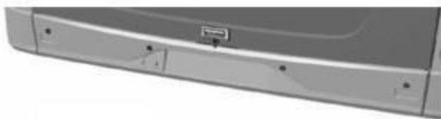
Am Kotflügel sind 4 Parksensoren angebracht. Sensor aktiviert, wenn der Rückwärtsgang eingelegt ist. Es umschlägt den Fahrer während der Umkehr entsprechend dem Abstand zwischen dem Kotflügel und den Rückwärtssperren.
