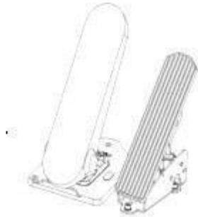
**Bremspedal:** Das Pedal links ist das Bremspedal. Dieses Pedal ist Teil des elektronischen Bremssystems (EBS). Ein elektrisches Signal wird an die zentrale Steuereinheit gesendet, wenn auf das Bremspedal gedrückt wird und die Luft auf Bremsen verteilt wird.
