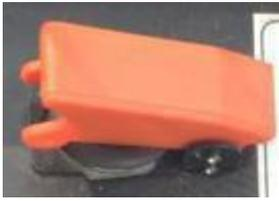
Um den Notschalter zu benutzen, wird die rot gefärbte Sicherheitsabdeckung an ihm durch Hochhalten geöffnet. Beim Vorschieben fällt der Strom des Systems ab, der Motor stoppt, alle internen Lichter und Gefahren gehen an, Türschalter sind in der aktiven und funktionsfähigen Position. Beim Zurückziehen wird das System normal.
