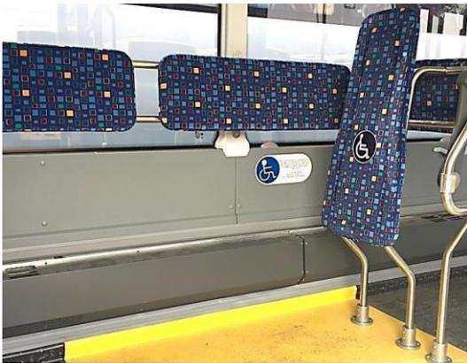
Vor der mittleren Tür befindet sich ein besonderer Platz für den Fahrgast, der mit dem Rollstuhl in das Fahrzeug einsteigt, um sicher zu reisen.
