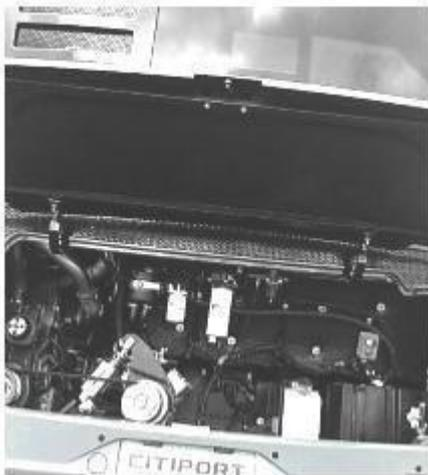
Der Kraftstoffwasserabscheider befindet sich im mittleren Bereich der Karosserie, wenn die Hecktür des Fahrzeugs geöffnet wird. Seine Funktion ist es, die effiziente Nutzung von Brennstoff durch Destillation des Wassers in Brennstoff. Zur Entleerung des im Brennstoff-Wasserabscheider-Filter aufgetürmten Wassers;
