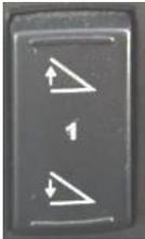
Beim Drücken auf das obere Ende des Schalters wird die vordere Dachentlüftung geöffnet. Er wird geschlossen, wenn er auf das untere Ende des Schalters gedrückt wird. Die Hintergrundbeleuchtung blinkt während der Auf- und Abbewegung der Dachentlüftung. Die Hintergrundbeleuchtung leuchtet beim Öffnen der Dachentlüftung. Die Dachentlüftung wird automatisch geschlossen, wenn Heizung, Klimaanlage oder Wischer in Betrieb waren.
