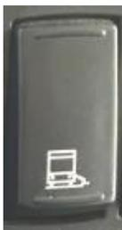
Wenn die behinderte Rampe unter der Aufsicht des Fahrers geöffnet wird, wenn auf das untere Ende des Schalters gedrückt wird, schaltet sich die Bremse automatisch ein. Wenn die Bremse am oberen Ende des Schalters betätigt wird, bricht sie nicht, es sei denn, die behinderte Rampe wird geschlossen, sie blockiert die Bewegung des Fahrzeugs, wenn die Rampe geöffnet wird.
