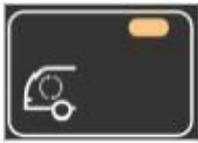
Der Frischluftknopf des Fahrers ermöglicht die Ansaugung von Luft von innerhalb oder außerhalb des Fahrzeugs. Es zeigt die Ansaugung der Ansaugluft, wenn led aktiv ist. Es zeigt Abluft Saugen, wenn geführt ist passiv.
