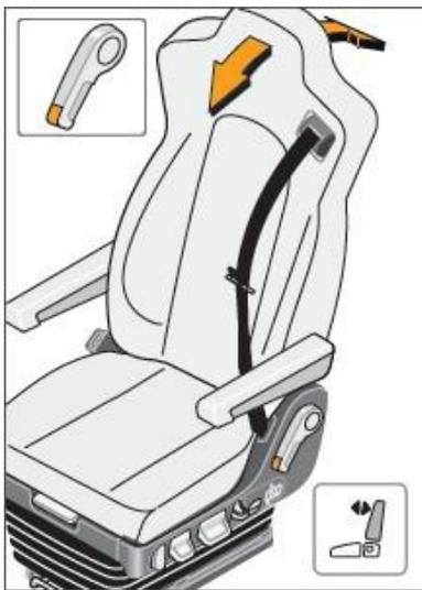
Die Schulterverstellung ermöglicht eine vollflächige Anlage an der Rückenlehne durch Neigungsverstellung des oberen Rückenlehnenbereichs. Diese Einstellung ermöglicht eine individuelle Anpassung des Sitzes an die Länge des Oberkörpers.
