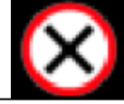
Akıllı Hız Asistanı Sistemi Kapalı ya da Sistemde bir arıza olması durumunda çarpı işaretli tabela ikonunun gösterimi
