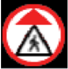
Ön Kör Nokta Algılama Sistemi araç önünde yaya, bisikletli vb. Algıladığında (Çarpışma riski yok) çıkan ikon gösterimi
