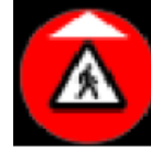
Ön Kör Nokta Algılama Sistemi araç önünde yaya, bisikletli vb. Algıladığında (Çarpışma riski yüksek) çıkan ikon gösterimi
