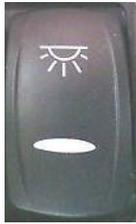
**Schalter für die Dachbeleuchtung:** Die Dachbeleuchtung wird eingeschaltet, wenn die untere Kante des Schalters gedrückt wird. Die Dachbeleuchtung wird ausgeschaltet, wenn die obere Kante des Schalters gedrückt wird.
