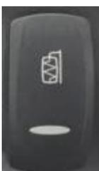
**Schalter für den Außenspiegelwiderstand:** Die Außenspiegelheizung wird aktiviert, wenn die untere Kante des Schalters gedrückt wird. Sie wird deaktiviert, wenn der Schalter ein zweites Mal gedrückt wird. Wenn die Heizung nicht vom Fahrer ausgeschaltet wird, wird sie nach 20 Minuten automatisch deaktiviert.
