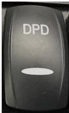
**DPD-Schalter:** Der DPD-Schalter wird verwendet, um die DPD manuell zu regenerieren.
