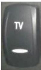
**Schalter für LCD-Bildschirm (optional):** Der LCD-Bildschirm wird eingeschaltet, wenn die untere Kante des Schalters gedrückt wird. Der LCD-Bildschirm wird ausgeschaltet, wenn Sie auf die obere Kante des Schalters drücken. Das Licht wird ausgeschaltet, wenn die obere Kante des Schalters gedrückt wird.
