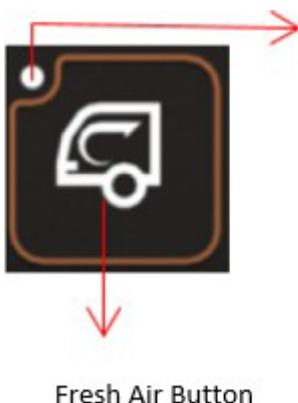
Die Frischlufttaste des Fahrers ermöglicht das Ansaugen von Luft aus dem Fahrzeuginneren oder von außen. Sie zeigt die Ansaugung der Einlassluft an, wenn die LED aktiv ist. Sie zeigt die Ansaugung der Auslassluft an, wenn die LED passiv ist.
