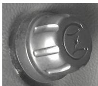
Dieser Drehknopf dient zum Aufwärmen des Motors. Durch Drehen des Knopfes im Uhrzeigersinn können Sie die Motordrehzahl erhöhen, ohne das Gaspedal betätigen zu müssen. Drehen Sie den Knopf nach dem Aufwärmen des Motors wieder ganz nach links und behalten Sie ihn in dieser Stellung.
