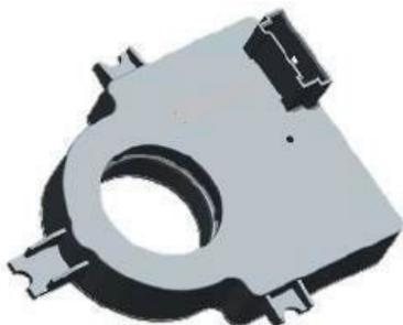
Der Winkelsensor verläuft durch die Lenkradsäule und ist unterhalb der Signalgruppe angeordnet. Er übermittelt die Lenkanforderung des Fahrers an das Steuergerät des Bremssystems in Abhängigkeit von der Drehung des Lenkrads. Die übertragenen Informationen werden als elektronisches Signal gesendet. Die Kalibrierung wird bei der Erstinstallation des Systems durchgeführt, um die Signale des Sensors und den Richtungswinkel des Fahrzeugs aufeinander abzustimmen.
