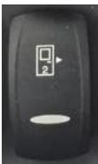
**Schalter für die Steuerung der Hintertür:** Die Hintertür wird geöffnet/geschlossen, wenn die untere Kante des Schalters gedrückt wird.
