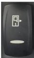
**Schalter zur Steuerung der Vordertür:** Die Vordertür wird geöffnet/geschlossen, wenn die Unterkante des Schalters gedrückt wird.
