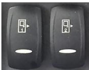
Am vorderen Bedienfeld befinden sich Schalter zum Öffnen/Schließen der Türen, mit denen die Türen von innen geöffnet/geschlossen werden können.
