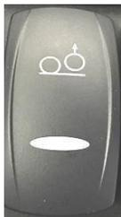
**Schalter zur Steuerung der Aufhängung:** Dieser Schalter wird für eine höhere Fahrstufe als die normale Fahrstufe verwendet. Wenn die untere Kante des Schalters gedrückt wird, erhält das Fahrzeug eine höhere Stufe und wenn die obere Kante des Schalters gedrückt wird, erhält das Fahrzeug die normale Fahrstufe. Wenn der Schalter eingeschaltet wird, ertönt ein intermittierender Warnton.
