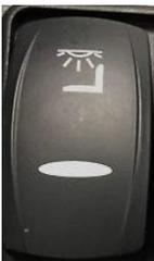
**Schalter für das Spotlicht:** Das Spotlicht an der Vordertür wird eingeschaltet, wenn die untere Kante des Schalters gedrückt wird. Das Licht wird ausgeschaltet, wenn die obere Kante des Schalters gedrückt wird.
