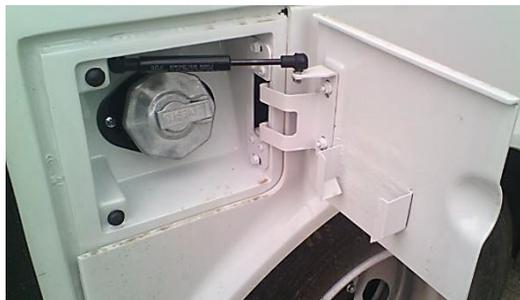
Öffnen und Schließen des Kraftstofftanks
