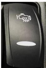
**Aufwärmeschalter:** Mit diesem Schalter kann das Kühlmittel bei niedrigen Temperaturen schneller erwärmt werden, um die Effizienz der Heizung zu erhöhen, oder um die Effizienz der Heizung zu erhöhen, während das Fahrzeug geparkt ist. Lassen Sie den Motor an und drücken Sie auf die Unterkante des Schalters. Nachdem der Motor warmgelaufen ist, drücken Sie auf die obere Kante des Schalters, um ihn auszuschalten.
