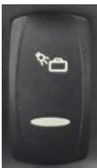
**Schalter für die Kofferraumklappe:** Die Beleuchtung im Kofferraum wird eingeschaltet, wenn die untere Kante des Schalters gedrückt wird. Die Lichter gehen aus, wenn die obere Kante des Schalters gedrückt wird.
