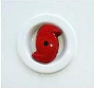
Auch an den Seiten der Türen befinden sich Lufthähne, um die Türen bei Bedarf von außen zu öffnen. Drehen Sie den Hahn im Uhrzeigersinn und ziehen Sie die Tür nach außen, um sie zu öffnen.
