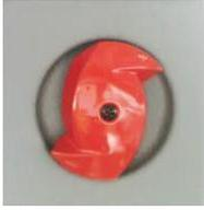
An der Oberseite der Türen befinden sich Lufthähne für Notfälle. Drehen Sie den Hahn im Uhrzeigersinn, um die Luft abzulassen, und drücken Sie die Tür zum Öffnen nach außen.
