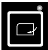
Beim Drücken der Taste leuchtet die grüne LED. In dieser Stellung wird die von der Frontheizung benötigte Frischluft von außen angesaugt.
