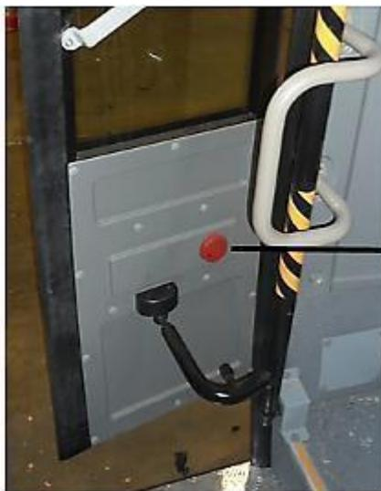
An der Tür befindet sich ein roter Ein-/Aus-Schalter zum Öffnen der Tür, wenn das Fahrzeug von außen mit dem Schlüssel verriegelt wird oder sich Passagiere im Inneren befinden. Bei Bedarf wird dieser Regler in Pfeilrichtung gedreht, die Luft wird durch Drehen des Entlüftungsventils an der Tür abgelassen und die Tür wird durch Drücken nach innen geöffnet.
