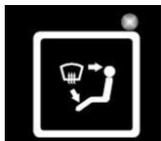
Beim Drücken der Taste leuchtet die grüne LED. Ein Teil der Luft wird zur Windschutzscheibe und zu den Lüftungsschlitzen geleitet.
