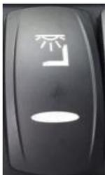
**Fahrerlichttaste:** Wenn der untere Teil der Taste gedrückt wird, schaltet sich das Licht ein. Das Licht erlischt, wenn der obere Teil der Taste gedrückt wird.
