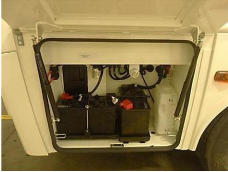
Das Fahrzeug verfügt über zwei Batterien mit jeweils 12 V und 105 Ah. Die Batterien befinden sich vor dem linken Vorderrad.
