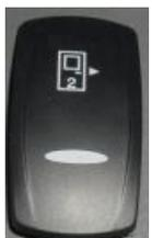
**Steuertaste für die hintere Tür:** Wenn der untere Teil der Taste gedrückt wird, öffnet/schließt sich die hintere Tür.
