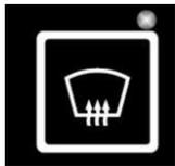
Beim Drücken der Taste leuchtet die grüne LED. Wird zum Entfrosten der Windschutzscheibe verwendet.
