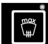
Wenn diese Taste gedrückt wird, wird Frischluft von außen angesaugt und die Gebläseeinheit erhöht sich allmählich und arbeitet mit der höchsten Geschwindigkeit.
