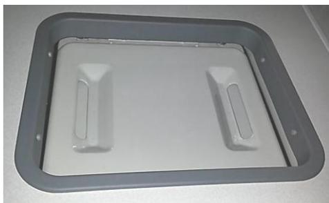
Zur Belüftung befindet sich im Dach eine manuell zu öffnende/schließende Dachluke.
