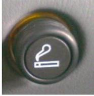
Das Feuerzeug wird gegen das Heizelement im Inneren gedrückt und kommt beim Erhitzen automatisch heraus.
