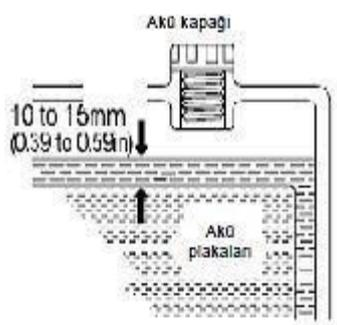
Wenn die Menge an Batterieflüssigkeit in der Batterie nicht ausreicht, entfernen Sie die Kappen und füllen Sie destilliertes Wasser nach, bis die Oberfläche nahe an der „TOP LEVEL“-Markierung liegt oder zwischen der Oberseite und den Batterieplatten ein Spalt von 10–15 mm besteht. Nachdem Sie den Ölstand überprüft haben, bringen Sie den Deckel und die Kappe fest an.
