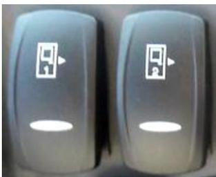
Auf dem vorderen Bedienfeld befinden sich Öffnungs-/Schließ Tasten zum Öffnen/Schließen der Türen von innen.
