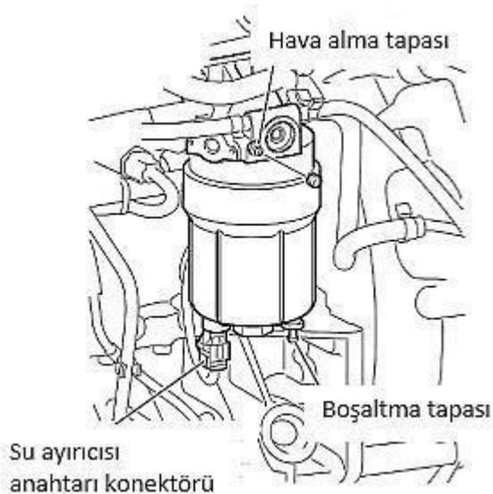
1. Lösen Sie die Ablassschraube unten am Filterelementbehälter. Entfernen Sie die Gummikappe des Entlüftungsstopfens und lösen Sie dann den Stopfen. Dadurch wird sichergestellt, dass das Öl im Filterelementbehälter durch die Ablassschraube abgelassen wird. Ziehen Sie den Entlüftungsstopfen fest.
