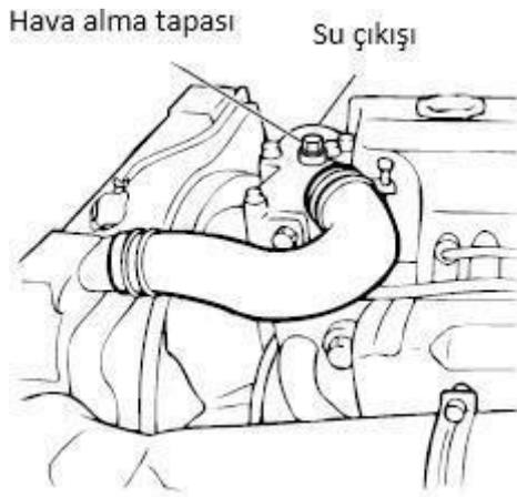
1. Ziehen Sie den Entlüftungsstopfen vom Wasserauslass ab (falls vorhanden). Füllen Sie den Kühler bis zum Deckel mit Leitungswasser. Nach dem Nachfüllen den Entlüftungsstopfen festziehen (Drehmoment 23,5 Nm).
