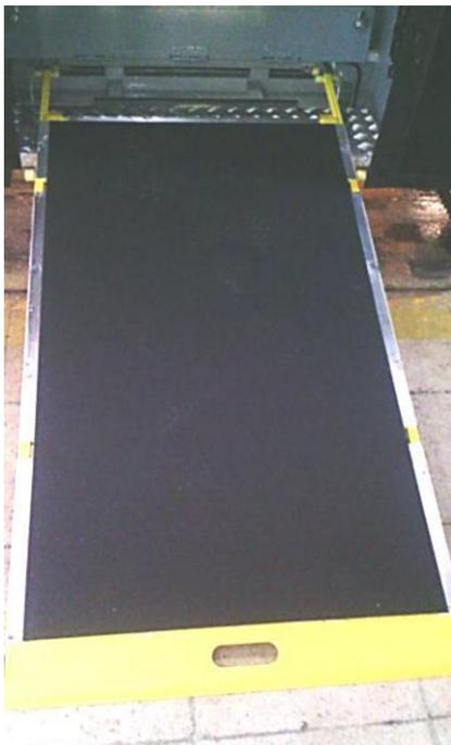
Die hintere Tür verfügt über eine manuell zu öffnende/schließende Rampe, damit behinderte Passagiere im Rollstuhl problemlos in das Fahrzeug ein- und aussteigen können.
