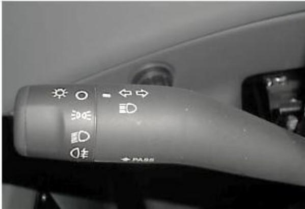
Es gibt ein Rechtssignal, wenn der Arm in die obere Position gebracht wird, und ein Linkssignal, wenn er in die untere Position gebracht wird. Mit der ersten Hebelumdrehung wird das Standlicht eingeschaltet, mit der zweiten Hebelumdrehung das Abblendlicht. Wenn der Hebel bei eingeschaltetem Abblendlicht nach unten gedrückt wird, schaltet sich das Fernlicht dauerhaft ein.
