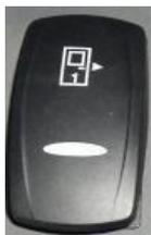
**Steuertaste für die Vordertür:** Wenn der untere Teil der Taste gedrückt wird, öffnet/schließt sich die Vordertür.
