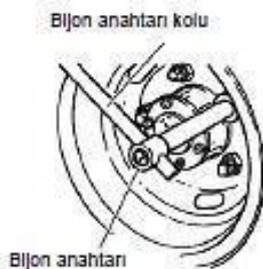
1. Ziehen Sie die Feststellbremse vollständig an. Wenn Sie ein Vorderrad wechseln, blockieren Sie das Hinterrad diagonal gegenüber dem Vorderrad. Wenn Sie ein Hinterrad wechseln, blockieren Sie das Vorderrad diagonal gegenüber dem Hinterrad.
