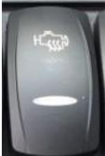
**Taste für Motorheizung:** Es wird aktiv, wenn Sie den unteren Teil der Taste drücken, und deaktiviert, wenn Sie den oberen Teil der Taste drücken.
