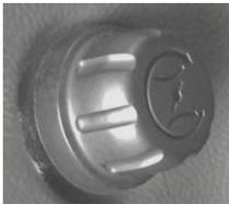
Diese Taste dient zum Aufwärmen des Motors. Sie können die Motorgeschwindigkeit erhöhen, indem Sie den Knopf im Uhrzeigersinn drehen, ohne das Gaspedal betätigen zu müssen. Nachdem Sie den Knopf zum Aufwärmen des Motors verwendet haben, drehen Sie den Knopf vollständig gegen den Uhrzeigersinn und halten Sie ihn in dieser Position.
