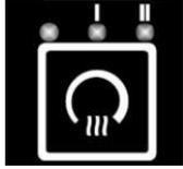
Steuerknopf für Heiß-Kalt-Ventil; Bei Betätigung der Taste leuchtet die blaue LED und befindet sich in der Sommerstellung. Es fließt kein heißes Wasser zum Heizgerät.
