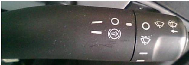
Der Scheibenwischer arbeitet in 3 Stufen.
