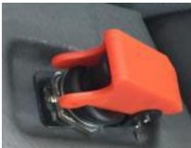
**Notfallknopf:** Um den Notfallknopf zu betätigen, wird die rote Sicherheitsabdeckung durch Hochschieben geöffnet. Wenn die Taste nach vorne gedrückt wird, wird die Stromversorgung im System unterbrochen, der Motor stoppt, alle Lichter und Blinker im Inneren werden eingeschaltet und die Türtasten werden aktiviert. Beim Zurückziehen der Taste kehrt das System in den Normalzustand zurück..
