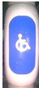
Passagiere, die aus dem Fahrzeug aussteigen möchten, informieren den Fahrer durch Drücken der Stopp-Tasten. Der Knopf der entsprechenden Tür leuchtet auf und auf der Digitaluhr erscheint das Wort „STOP“. Zusätzlich wird auch eine akustische Warnung aktiviert. Beim Öffnen der Türen verschwindet die Meldung „STOP“ vom Display und die Warnleuchten an den Türtasten erlöschen.
