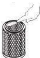
5. Testen Sie die Haltbarkeit der Dichtung am neuen Filter.
