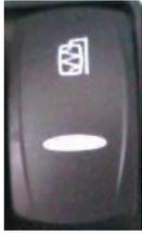
**Widerstandstaste für Außenspiegel:** Durch Drücken des unteren Teils der Taste wird die Außenspiegelheizung aktiviert. Bei erneutem Drücken wird die Funktion deaktiviert. Wenn die Heizung nicht vom Fahrer ausgeschaltet wird, wird sie nach 20 Minuten automatisch deaktiviert.
