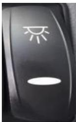
**Deckenlampentaste:** Wenn der untere Teil der Taste gedrückt wird, schaltet sich die Deckenbeleuchtung ein. Durch Drücken des oberen Teils der Taste wird die Deckenbeleuchtung ausgeschaltet.
