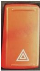
Der Warnblinker wird verwendet, um anderen Fahrzeugen zu signalisieren, dass Ihr Fahrzeug aufgrund eines Unfalls oder eines Komponentenausfalls auf der Straße steht.
