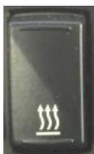
Heizungsschalter verwenden, um die Heizung zu aktivieren. Drücken Sie den Heizungsschalter, um die Heizung einzuschalten, drücken Sie erneut, um die zweite Ebene der Heizung zu aktivieren. Drücken Sie den Schalter zum dritten Mal, um ihn auf "AUS" zu schalten.
