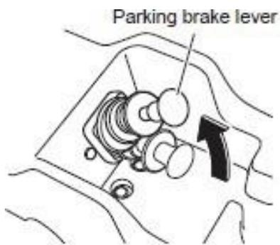
Ziehen Sie den Feststellbremshebel aus der vollständig gelösten Stellung in die verriegelte Stellung des Hebels. Die Warnleuchte der Feststellbremse leuchtet dann auf. Stellen Sie sicher, dass Sie hören, wie die Luft aus dem System freigegeben wird.
