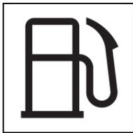
Diese Warnleuchte leuchtet auf, wenn der Kraftstoffstand im Tank bei laufendem Motor zu niedrig wird.
