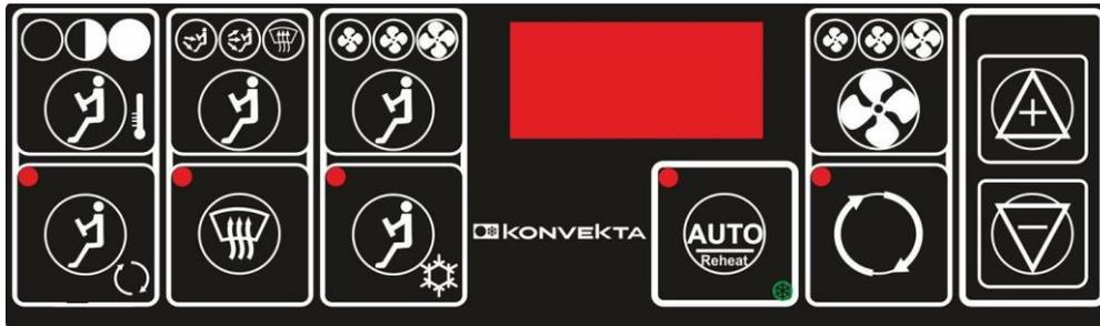
Auf der Vorderseite befinden sich 11 Tasten für verschiedene Bedienungen der Klimaanlage. Auf dem siebensegmentförmigen, dreistelligen Display (D) in der Fahrgastraumsteuerung werden Parameterwerte und andere Informationen, wie z.B. die Soll- (Soll-) und die aktuelle Temperatur angezeigt.
