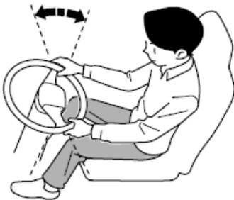
Während der Motor im Leerlauf ist, das Lenkrad in die gerade Position nach vorne stellen, dann vorsichtig mit der Hand nach links und rechts drehen und das Spiel im Lenkrad als Umfangsabstand zu dem Punkt überprüfen, wo die Reifen beginnen, sich zu bewegen.
