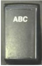
Benutzen Sie die Zielanzeige, um die Anzeige der Zielroute zu aktivieren. Drücken Sie bei eingeschaltetem Startschalter den Zielanzeigeschalter, um die Anzeige der Zielanzeige einzuschalten. Drücken Sie den Schalter erneut, um ihn auf "AUS" zu schalten.
