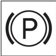
Diese Warnleuchte leuchtet auf, wenn der Feststellbremshebel hochgezogen wird.
