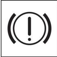
Diese Warnleuchte sollte leuchten, wenn der Anlassschalter in die Stellung "EIN" geschaltet wird, und dann nach dem Start des Motors ausgehen.
