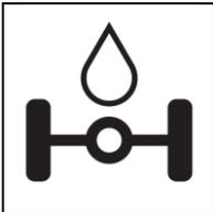
Das automatische Schmiersystem dient zur Schmierung der Vorderachse zu bestimmten Zeiten.
