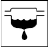
Wenn sich eine bestimmte Wassermenge im Wasserabscheider (dem motorseitigen Kraftstofffilter) angesammelt hat, leuchtet die Warnleuchte Wasserabscheider (Kraftstofffilter) auf. In diesem Fall das Wasser ablassen und sicherstellen, dass die Warnleuchte erloschen ist.
