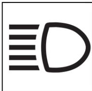
Diese Signalleuchte leuchtet auf, wenn das Fernlicht ausgewählt oder die Scheinwerfer zwischen Hoch- und Tieflicht getaktet werden (Durchlasssignal).
