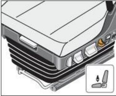
Schützt die Wirbelsäule des Fahrers, da der Dämpfer die vertikalen Stöße und Vibrationen absorbiert. Durch die Einstellung des Dämpfers kann das Federungsverhalten des Sitzes optimal an jede Fahrbahn und jeden Fahrer angepasst werden.
