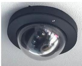
Innerhalb des Fahrzeuges 3 befinden sich 5 Kameras, die zur Steuerung der Ein- und Ausfahrt der Fahrgäste dienen, und je eine zur Beobachtung des Fahrers und der Straße. Die von der Kamera erhaltenen Visierpunkte werden auf dem LCD-Display auf dem vorderen Bedienfeld überwacht.
