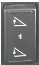
Verwenden Sie den vorderen Dachlüftungsschalter, um die Dachbelüftung an der Vorderseite des Fahrzeugs zu aktivieren. Drücken Sie das obere Ende des Schalters zum Öffnen und das untere Ende zum Schließen der Lüftung.
