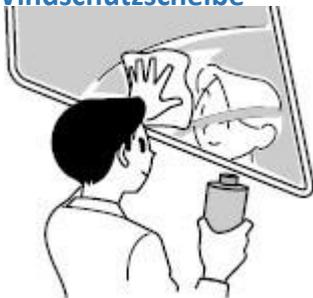
Falls die Scheibenwischer die Scheibe nicht vollständig reinigen, sollte die Scheibe mit einem Isuzu-Original-Glasreiniger gereinigt werden.
