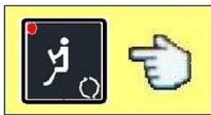
Wenn die Klappentaste einmal gedrückt wird, schaltet die Klimaanlage für den Fahrerraum vom Frischluftbetrieb in den Umluftbetrieb um. Die entsprechende LED leuchtet auf. Die Klimaanlage für den Fahrerraum läuft üblicherweise im Frischluftbetrieb. Die entsprechende LED leuchtet nicht auf.
