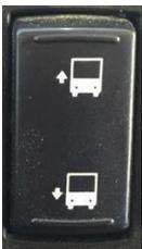
Verwenden Sie den Fahrhöheschalter, um eine höhere Fahrstufe beizubehalten. Drücken Sie das obere Ende des Schalters, um eine höhere Fahrstufe beizubehalten, und das untere Ende, um in die normale Fahrstufe zurückzukehren.
