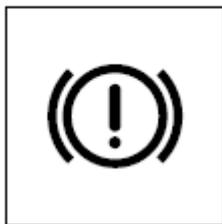
Wenn der Startschalter in die Stellung "EIN" geschaltet wird, leuchtet die Bremswarnleuchte auf, bevor sie etwa 3 Sekunden später erlischt. Die EBS ist normal, wenn die Warnleuchte erlischt. Wenn die Warnleuchte auch bei eingeschaltetem Anlassschalter nicht leuchtet, kann es sein, dass die Glühbirne ausgebrannt ist oder eine EBS-Störung vorliegt.
