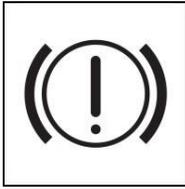
Wenn diese Warnleuchte aufleuchtet, herrscht im Druckluftbehälter kein ausreichender Luftdruck und die Bremsen funktionieren nicht richtig. Zu diesem Zeitpunkt ertönt ein Warnsummer.
