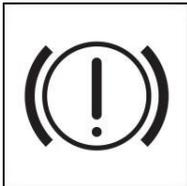
Diese Warnleuchte sollte beim Einschalten des Anlassschalters in die Stellung "EIN" aufleuchten und nach ca. 3 Sekunden erlöschen.
