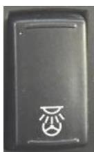
Der fahrerseitige Deckenlichtschalter kann verwendet werden, wenn der Anlassschalter in die Stellung "EIN" gebracht wird. Verwenden Sie diesen Schalter zum Öffnen und Schließen der fahrerseitigen Deckenleuchte.
