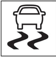
Wenn der Startschalter in die Stellung "EIN" geschaltet wird, leuchtet die ESC-Warnleuchte auf, bevor sie nach etwa 3 bis 5 Sekunden erlischt. Diese Warnleuchte leuchtet immer dann auf, wenn ein Problem in der elektronischen Stabilitätskontrolle (ESC) vorliegt. Wenn die ESC aktiv ist, blinkt die ESC-Warnleuchte.
