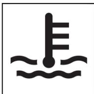
Diese Warnleuchte leuchtet auf, wenn der Motor überhitzt ist. Wenn der Motor überhitzt, erreicht die Nadel des Motorkühlmittel-Temperaturmessers die rote Zone, und die Warnleuchte für die Motorüberhitzung leuchtet auf, und gleichzeitig ertönt ein Summer. Sofort an einen sicheren Ort ziehen, überprüfen Sie das Fahrzeug und ergreifen Sie die notwendigen Maßnahmen.
