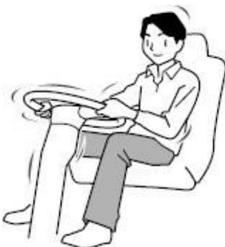
Ergreifen Sie das Lenkrad mit beiden Händen, und bewegen Sie es in axialer Richtung und auch auf und ab, und links und rechts, um zu sehen, ob es eine Lockerheit.
