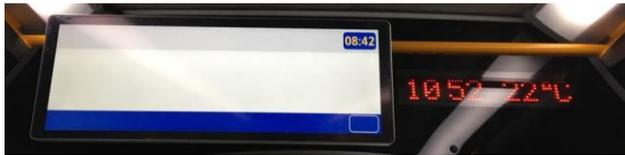
Es gibt ein 19" LCD-Display an der Vorderseite des Fahrzeugs. Dieser Bildschirm kann für die informierenden Passagiere und für Anzeigenimpressionen verwendet werden.
