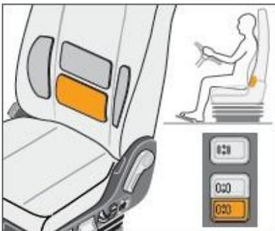
Fördert eine aufrechte Haltung und verhindert Ermüdung durch Abstimmung der Rückenkontur. Durch diese veränderbare Form der unteren Rückenlehne wird die Position des Beckens des Fahrers durch Vorwärts- und Aufwärtsdrehen des Beckens eingestellt.
