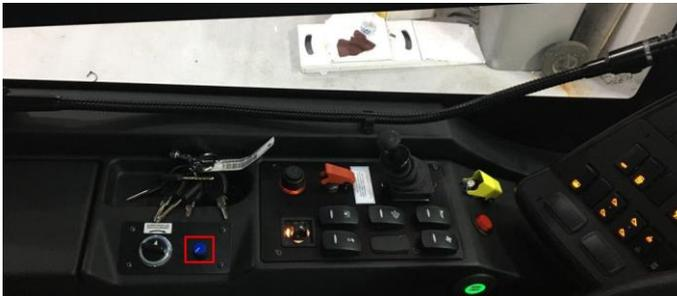
Auf der linken Seite der Treiberkonsole befindet sich ein Mikrofon. Der Ton wird vom Potenziometer, das im Bild rot markiert ist, an- und abgeschaltet.
