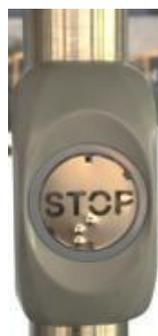
Die Fahrgäste, die aus dem Fahrzeug steigen wollen, informieren den Fahrer durch Drücken dieser Tasten. Die zugehörigen Türknopflampen und der "STOP"-Ausdruck sind auf der Fahrgastinformationstafel zu sehen. Zusätzlich wird eine akustische Warnung aktiviert. Wenn Türen geöffnet werden, schalten sich der "STOP"-Artikel und die Warnleuchten an den Türknöpfen aus.
