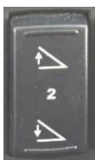
Verwenden Sie den hinteren Dachlüftungsschalter, um die Dachbelüftung an der Rückseite des Fahrzeugs zu aktivieren. Drücken Sie das obere Ende des Schalters zum Öffnen und das untere Ende zum Schließen der Lüftung.
