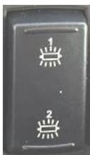
Verwenden Sie den Deckenlichtschalter, um die Modi der Deckenleuchte zu steuern. Je nach Stellung des Schalters: Leuchten teilweise einschalten, Leuchten vollständig einschalten oder Leuchten ausschalten.
