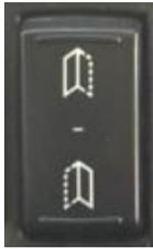
Verwenden Sie den Flügelwahlschalter der Fronttür, um zu steuern, welcher Flügel der Fronttür geöffnet werden soll. Je nach Stellung des Schalters: nur linker Flügel, nur rechter Flügel oder beide Flügel offen.
