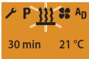
Anzeige für Luftheizungen im Dauerbetrieb (Werkseinstellung).
