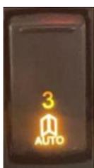
Die dritte Tür kann von den Fahrgästen durch Drücken der Stopp-Tasten an den Handläufen an den Seiten der dritten Tür geöffnet werden, wenn der Bus im Stillstand war und die "Türfreigabetaste" an der Fahrerkonsole vom Fahrer aktiviert wurde. Die Fahrer sollten aufgefordert werden, die "Türentriegelung"-Taste zu deaktivieren, bevor die Busfahrt nach
