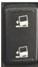
Verwenden Sie den Knieschalter, um das Fahrzeug nach rechts zu kippen. Drücken Sie das untere Ende des Schalters, um das Fahrzeug zu kippen, und das obere Ende, um in die Fahrposition zurückzukehren.
