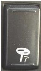
Zum Entriegeln und Einstellen der Lenkradposition drücken Sie den Lenkradeinstellschalter. Drücken Sie den Schalter erneut, um die Position des Lenkrads zu verriegeln.
