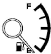
Wenn der Kraftstoff ausläuft, wird Luft in das Kraftstoffsystem, sodass Betanken allein nicht genug sein, um den Motor neu zu starten. Bitten Sie den nächstgelegenen Isuzu-Händler, das Kraftstoffsystem zu entlüften.
