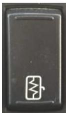
Verwenden Sie die Spiegelheizung zum Abtauen der Spiegeloberfläche. Drücken Sie bei eingeschaltetem Anlassschalter auf den Spiegel-Heizschalter, um den Spiegel-Heizer einzuschalten. Drücken Sie den Schalter erneut, um ihn auf "AUS" zu schalten.
