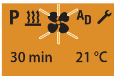
Anzeige für Luftheizungen im Dauerlüftungsbetrieb.
