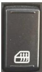
Verwenden Sie die fahrerseitige Fensterheizung, um die fahrerseitige Fensterfläche aufzutauen. Drücken Sie bei eingeschaltetem Anlassschalter den Fensterheber-Schalter, um den Fensterheber einzuschalten. Drücken Sie den Schalter erneut, um ihn auf "AUS" zu schalten.
