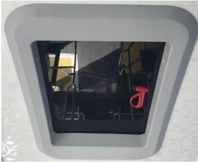
Es gibt 2 Falltüren inklusive Vorder- und Rückseite im Fahrzeug. Sie werden elektrisch gesteuert. Die Öffnungs-/Schließvorgänge der Deckel entsprechend der gewünschten Richtung des Lufteinlasses werden mit dem Luftzustandsschalter am vorderen Bedienfeld realisiert. Falltüren sind so konzipiert, dass sie bei Bedarf als Notausgänge verwendet werden können.
