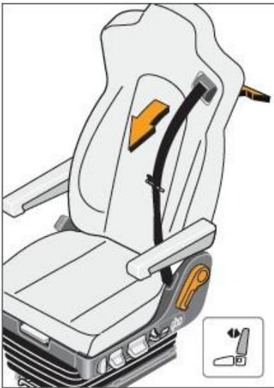
Die Rückenlehnenverstellung ist notwendig, um dem Fahrer eine aufrechte Haltung für eine gute Sicht auf den Verkehr zu ermöglichen.
