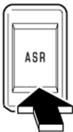
Verwenden Sie diesen Schalter, wenn Sie die ASR abbrechen möchten. Wenn Sie diesen Schalter drücken, während der ASR nach dem Starten des Motors aktiv ist, wird der ASR gelöscht und die ASR-Anzeigeleuchte (gelb) in der Instrumententafel leuchtet. Wenn der Schalter wieder gedrückt wird, schaltet sich die ASR-Funktion wieder ein.
