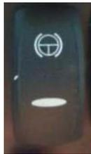
Das System wird durch Drücken der unteren Kante des Schalters geöffnet, damit der Retarder aktiviert wird. Wenn der Retarder eingeschaltet ist, kann er mit dem Retardergriff aktiviert werden oder wenn das Bremspedal gedrückt wird, wird der Retarder automatisch aktiviert. Das System wird geschlossen, wenn die Oberkante des Schalters gedrückt wird.
