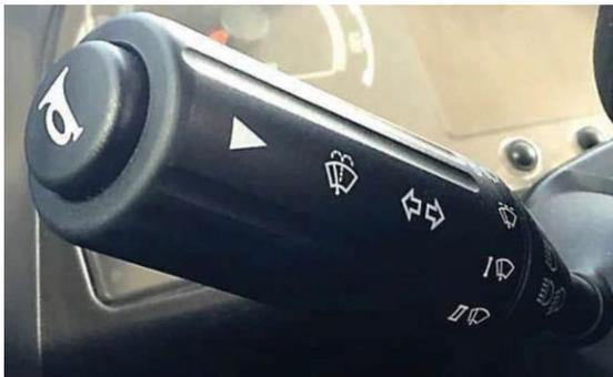
Der Hebel signalisiert nach links, während er sich in Abwärtsrichtung befindet, und nach rechts, während er sich in Aufwärtsrichtung befindet. Bei der ersten Umdrehung aktiviert er intermittierend die Wischer, bei der zweiten, bei Normalgeschwindigkeit und bei der dritten, bei hoher Geschwindigkeit. Der Wassersprinkler läuft, wenn er in Richtung Lenkrad geschoben wird. Wenn der Knopf am Ende gedrückt wird, wird das Horn aktiviert.
