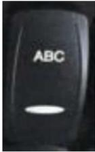
Die Fahrtrichtungsanzeige wird beim Drücken des unteren Teils des Schalters aktiviert und beim Drücken des oberen Teils deaktiviert.
