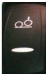
Dieser Schalter ermöglicht eine automatische oder manuelle Steuerung der Seitwärts kippenfunktion des Aufhängungssystems beim Öffnen der Türen.
