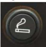
Feuerzeug wird auf das innere Heizelement geschoben und wirft bei Erwärmung automatisch aus.
