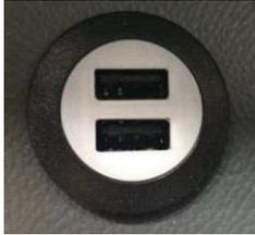
Auf dem seitlichen Bedienfeld befindet sich ein Ladegerät mit USB-Anschluss, über den der Fahrer sein Mobiltelefon aufladen kann. Es gibt zwei Steckdosen für normales und schnelles Laden.
