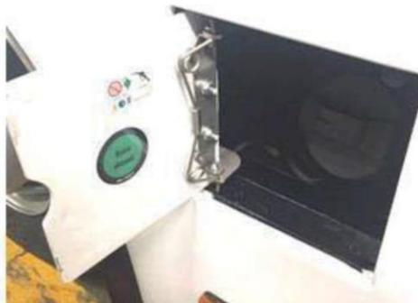
Die Schutzabdeckung muss vor der Tankabdeckung geöffnet werden. Der Deckel wird mit dem Tankschlüssel geöffnet. Nach dem Befüllen wird der Tankdeckel durch Drehen im Uhrzeigersinn verriegelt. Unter der Vorderachse des Fahrzeugs und knapp über der Rahmenkonstruktion steht ein Ablassstopfen des Kraftstoffbehälters zur Verfügung. Der Stopfen wird durch Drehen geöffnet und die Rückstände werden aus dem Kraftstofftank ausgetragen.
