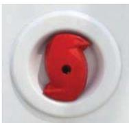
Es gibt auch Ablassventile, um die Türen bei Bedarf von außen zu öffnen. Drehen Sie das Ventil im Uhrzeigersinn und öffnen Sie die Türen, indem Sie nach innen drücken.
