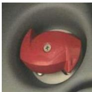
Die Türen sind mit Ablassventilen für Notfälle ausgestattet. Falls erforderlich, entlüften Sie durch Drehen des Ventils im Uhrzeigersinn und öffnen Sie die Türen durch Ziehen nach innen.
