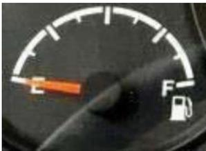
Die Kraftstoffanzeige zeigt den Kraftstoffstand im Kraftstofftank. Das gelbe Licht rechts unten am Display blinkt, wenn sich das Zifferblatt dem Buchstaben "E" nähert, was bedeutet, dass der Treibstoff langsam wird. Der Kraftstoff sollte hinzugefügt werden, bevor der Kraftstoff im Tank vollständig ausläuft, sonst wird das System mit Luft gefüllt.
