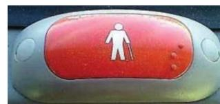
Fahrgäste, die aus dem Fahrzeug steigen wollen, informieren den Fahrer durch Drücken dieser Tasten. Der entsprechende Türknopf blinkt auf und die Meldung "STOP" erscheint auf der digitalen Uhr. Zusätzlich wird auch der Summer aktiviert. Wenn die Türen geöffnet werden, blinken die Worte "STOP" und die Warnleuchten an der Tür ab.
