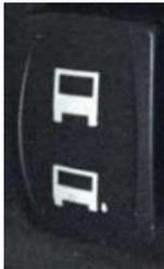
Beim Drücken des unteren Teils des Schalters Seitwärts kippt das Fahrzeug nach rechts und beim Drücken des oberen Teils kehrt es in die normale Fahrposition zurück. Das System wird deaktiviert, wenn das Oberteil gedrückt wird.
