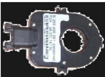
Der Winkelsensor durch die Lenksäule befindet sich unter der Signalgruppe. Er übermittelt die Manövriervorgabe des Fahrers an die Bremsanlagensteuerung entsprechend dem Betrag der Lenkraddrehung. Die übertragenen Informationen werden als elektronisches Signal gesendet. Die Kalibrierung erfolgt bei der Erstinbetriebnahme des Systems, um das Signal des Sensors an den Drehwinkel des Fahrzeugs anzupassen.
