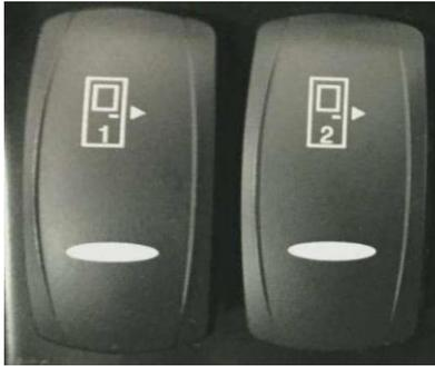
An der vorderen Schalttafel befinden sich Ein-/Ausschalter zum Öffnen/Schließen der Türen von innen. Die Türen schließen sich automatisch, wenn die Fahrzeuggeschwindigkeit 5 km/h überschreitet. Die Fronttür öffnet/schließt mit einer Fernbedienung von außen.
