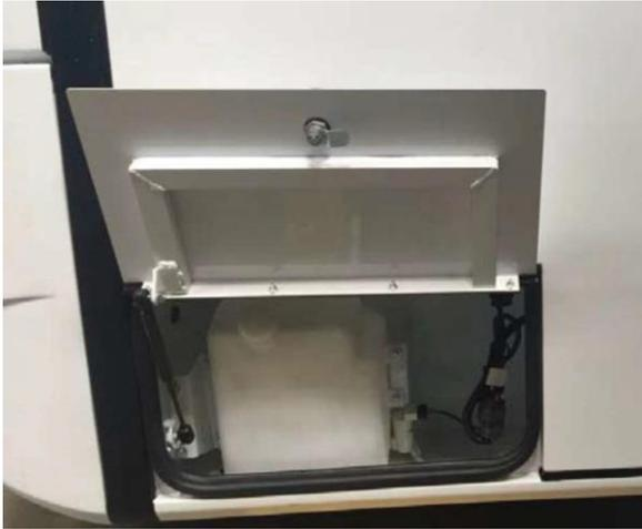
Fenster Sprinkler Wassertank kann durch Öffnen der vorderen linken Karosserieabdeckung zugegriffen werden. Nach Öffnen des Deckels können maximal 10 Liter Fensterwaschwasser gefüllt werden.
