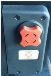
Gleichzeitig ist an der Tür ein rotes Ein-/Ausschalt Schloss angebracht, das die Tür mit einem Schlüssel von außen öffnet, wenn das Fahrzeug verriegelt ist oder wenn Passagiere drinnen sind. Wenn nötig, drehen Sie dieses Schloss in Pfeilrichtung, entladen Sie die Luft durch Drehen des Ablassventils an der Tür und öffnen Sie die Tür durch Ziehen nach innen.
