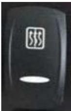
Beim Drücken des unteren Teils des Schalters wird der fahrerseitige Fensterwiderstand aktiviert. Wird er vom Fahrer nicht ausgeschaltet, wird er nach 20 Minuten automatisch deaktiviert.
