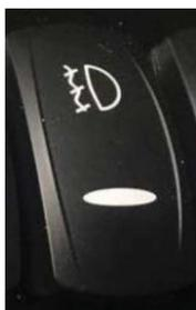
Die Nebelscheinwerfer leuchten auf, wenn der Schalter unten gedrückt wird. Sie blitzen ab, wenn sie wieder gedrückt werden.
