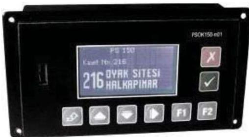
Auf dem oberen Teil des Fahrerraums befindet sich ein Bedienfeld für die Routenanzeige. Die Routeninformation wird über das Bedienfeld ausgewählt/geändert.
