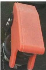
Um den Notschalter zu benutzen, heben Sie ihn nach oben und öffnen Sie die rote Sicherheitsabdeckung. Beim Vorschieben wird der Strom im System abgeschaltet, der Motor stoppt, alle Innenbeleuchtungsleuchten und die Warnleuchten leuchten auf und die Türschalter sind in einem aktiven Betriebszustand. Nach dem Zurückziehen kehrt das System zur Normalität zurück.
