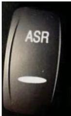
Das ASR-System ist deaktiviert, wenn das untere Ende des Schalters gedrückt wird. Die ASR wird aktiviert, wenn das obere Ende des Schalters gedrückt wird.
