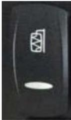
Beim Drücken des unteren Teils des Schalters wird der Außenrückspiegelwiderstand aktiviert. Beim zweiten Drücken wird er deaktiviert. Wird er vom Fahrer nicht ausgeschaltet, wird er nach 20 Minuten automatisch deaktiviert.
