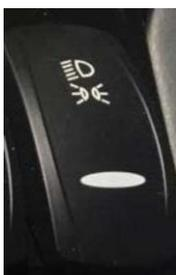
Die Parkleuchten leuchten, wenn das untere Ende des Schalters einmal gedrückt wird. Beim zweiten Drücken blinken die Abblendlichter an. Die Abblendlichter blinken ab, wenn das obere Ende des Schalters wieder gedrückt wird, die Parkleuchten blinken ab, wenn der Knopf das zweite Mal gedrückt wird.
