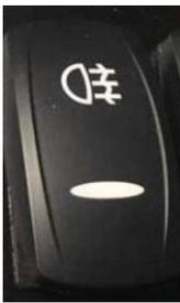
Bei geöffnetem Abblendlicht blinkt die Nebelschlussleuchte beim Drücken des unteren Endes des Schalters und beim Drücken des oberen Endes blinkt sie ab. Wenn die Abblendlichter nicht blinken, blinkt die Nebelschlussleuchte nicht.
