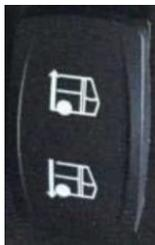
Dieser Schalter dient dazu, das Fahrzeug auf einem höheren oder niedrigeren Fahrniveau als normal zu fahren. Beim Drücken des oberen Teils des Schalters schaltet das Fahrzeug auf eine höhere Fahrstufe und beim Drücken des unteren Teils sinkt die Fahrstufe.
