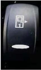
Die Fronttür wird geöffnet/geschlossen, wenn der untere Teil des Schalters gedrückt wird. Der Schalter ist nicht aktiv, wenn die Fahrzeuggeschwindigkeit 5 km/h überschreitet.
