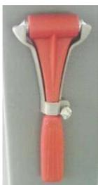
Im Notfall kann der Notausstieg durch Brechen der Fenster auf der rechten und linken Fahrzeugseite mithilfe des Nothammers erfolgen.
