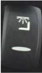
Beim Betätigen des unteren Teils des Schalters blinkt die Spotleuchte oben im Fahrerraum ein und beim Betätigen des oberen Teils blinkt die Leuchte aus.
