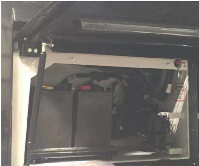
Batterien befinden sich in der Kabine an der Rückseite des Fahrzeugs. Im Fahrzeug befinden sich 2 Batterien. Jeder Akku ist 12 V und 125 Ah.
