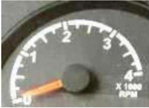
Der Tachometer misst die Drehzahl des Motors pro Minute. Es läuft, wenn der Motor gestartet wird.
