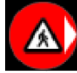
Sağ Kör Nokta Algılama Sistemi araç sağında yaya, bisikletli vb. Algıladığında (Çarpışma riski yüksek) çıkan ikon gösterimi
