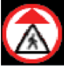
Ön Kör Nokta Algılama Sistemi araç önünde yaya, bisikletli vb. Algıladığında (Çarpışma riski yok) çıkan ikon gösterimi
