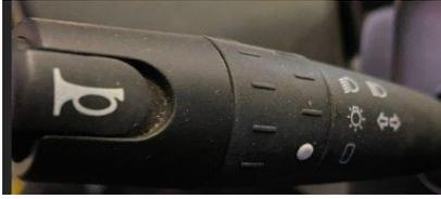
Funktioniert bei aktiviertem Zündschlüssel. Wird der Hebel nach unten gedrückt, blinkt das Fahrzeug links; nach oben gedrückt, blinkt es rechts. Beim Ziehen des Hebels zum Fahrer hin wird die Lichthupe aktiviert. Beim Drehen um eine Stufe werden die Standlichter eingeschaltet, beim Drehen um zwei Stufen das Abblendlicht. Ist das Abblendlicht eingeschaltet und der Hebel wird zum Fahrer gezogen, wird das Fernlicht aktiviert. Beim Drücken der Taste mit dem Hupensymbol wird die Hupe betätigt.
