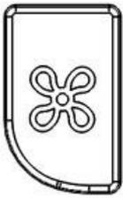
Wenn Sie die Taste mit dem Lüfter-Symbol drücken, wird die Heizstufe geändert, wenn die Heizung aktiv ist. Sie können die Heizstufen auf maximal, mittel und ökonomisch einstellen.
