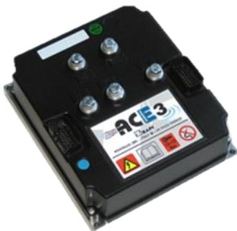
Das Motorsteuergerät sorgt dafür, dass Beschleunigungs- und Verzögerungswünsche des Fahrers über das Gaspedal und Bremspedal sicher umgesetzt werden. Es interpretiert zudem Daten wie Motortemperatur und Motordrehzahl und überträgt diese an die Fahrzeugkommunikationsleitung. Auch der Ladevorgang der Batterie durch regeneratives Bremsen wird durch das Motorsteuergerät gesteuert.
