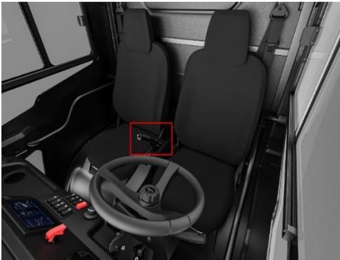
Die Handbremse ist ein Seilzug- und Zughebelsystem. Der Handbremshebel befindet sich unten rechts vom Fahrersitz. Beim Anhalten des Fahrzeugs wird der Hebel nach oben gezogen. Zum Lösen der Bremse wird der Riegel am Ende des Hebels gedrückt. Auf dem Armaturenbrett befindet sich eine Warnleuchte, die den Status der Handbremse anzeigt.
