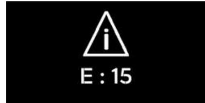
Wenn Sie die Einschalttaste erneut drücken, wird der Fehler zurückgesetzt und Ihr Heizer eingeschaltet.
