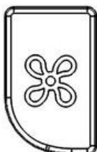
Wenn die Taste mit dem Lüftersymbol gedrückt wird, ändert der Heizer die Lüfterstufe, wenn der Lüfter aktiv ist.
