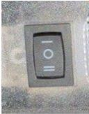
Funktioniert unabhängig vom Zündschlüssel. Beim Drücken des Symbols „I“ leuchtet das Innenlicht dauerhaft. Beim Drücken des Symbols „II“ leuchtet das Licht, wenn die Türen geöffnet werden.
