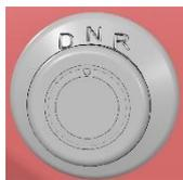
Funktioniert bei aktiviertem Zündschlüssel. Durch Drücken des Bremspedals kann der Gangwechsel durchgeführt werden. Das Fahrzeug schaltet dann in die Stellung „D“ oder „R“.
