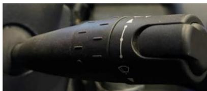
Funktioniert bei aktiviertem Zündschlüssel. Wird der Hebel einmal nach unten gezogen und losgelassen, arbeitet der Wischer einmal im ersten Intervall. Beim einmaligen Hochbewegen arbeitet er intermittierend. Beim weiteren Hochbewegen arbeitet der Wischer kontinuierlich im ersten Gang, und beim nochmaligen Hochbewegen im zweiten Gang. Wird der Hebel zum Fahrer gezogen, wird die Scheibenwaschanlage aktiviert.
