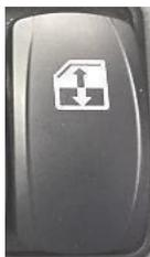
**Elektrisch betätigter Fensterschalter:** Das Fenster fährt nach unten, wenn es am unteren Ende des Schalters gedrückt wird, hält an, wenn es erneut gedrückt wird, und fährt nach oben, wenn es am oberen Ende gedrückt wird.
