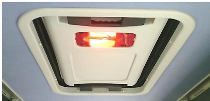
Der Notausstieg wird durch Einschlagen der Fenster auf der rechten und linken Seite des Fahrzeugs und des Fensters der Falltür mit dem Nothammer ermöglicht.
