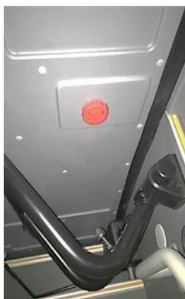
An der Tür befindet sich ein roter Schalter zum Öffnen/Schließen des Schlosses, mit dem die Tür geöffnet werden kann, wenn sich ein Fahrgast im Fahrzeug befindet und die Tür von außen mit dem Schlüssel verriegelt ist. Der Regler wird bei Bedarf in Pfeilrichtung gedreht und die Luft wird durch Drehen des Lufthahns an der Oberseite der Tür abgelassen; zum Öffnen wird die Tür nach außen geschoben.
