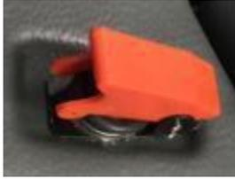
**Notschalter:** Die rote Sicherheitskappe wird geöffnet, indem sie nach oben bewegt wird, um den Notschalter zu betätigen. Die Stromzufuhr zum System wird unterbrochen, der Motor wird abgestellt, alle Innenbeleuchtungen und Blinker werden eingeschaltet und die Türschalter werden aktiviert, wenn der Schalter nach vorne gedrückt wird. Das System wird wieder normal, wenn es zurückgezogen wird.
