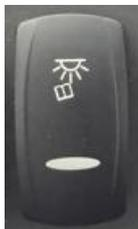
**Schalter für Leselampen:** Der Schalter funktioniert in zwei Stufen. Er öffnet sich auf der ersten Stufe, wenn die untere Kante gedrückt wird, und wenn der Beifahrer den Schalter für die Leselampe am Service-Set einschaltet, geht die Lampe an. Wenn er ausgeschaltet wird, geht sie aus. Die Leselampen werden auf der zweiten Stufe eingeschaltet, wenn die untere Kante zum zweiten Mal gedrückt wird, sie dürfen nicht vom Beifahrer bedient werden.
