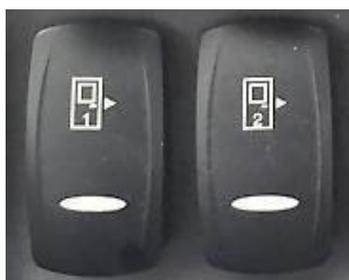
Am vorderen Bedienfeld befinden sich Schalter zum Öffnen/Schließen der Türen, mit denen die Türen von innen geöffnet/geschlossen werden können.
