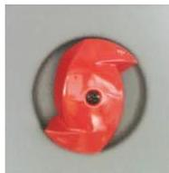
An der Oberseite der Türen befinden sich Lufthähne für Notfälle. Drehen Sie den Hahn im Uhrzeigersinn, um die Luft abzulassen, und drücken Sie die Tür zum Öffnen nach außen.
