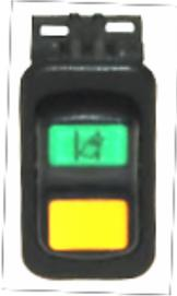
**LDWS-Schalter (optional)** : Sie können das System für einen Zeitraum von 10 Minuten auf Straßen ohne klare Fahrbahnmarkierungen deaktivieren, um Fehlalarme zu vermeiden. Drücken Sie diesen Schalter, um das System zu deaktivieren.
