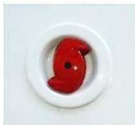
Auch an den Seiten der Türen befinden sich Lufthähne, um die Türen bei Bedarf von außen zu öffnen. Drehen Sie den Hahn im Uhrzeigersinn und ziehen Sie die Tür nach außen, um sie zu öffnen.
