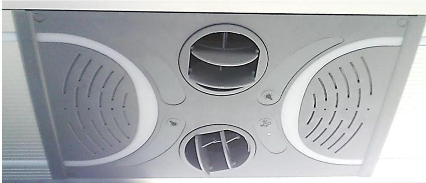
An der Oberseite der Sitze befinden sich Servicegeräte. Es gibt zwei Luftauslassdüsen, eine Hostessentaste und zwei Tasten zur Aktivierung der Leselampen an den Service-Sets. Die Düsen werden durch Drücken der Flügel an den Luftauslassdüsen geöffnet, um den Luftauslass zu aktivieren. Die Flügel können nach hinten und vorne bewegt werden, um die Luftmenge einzustellen. Die Richtung kann durch Drehen geändert werden.
