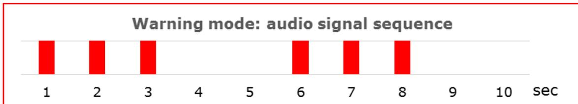
Ein kurzes Drücken auf den Knopf schaltet das akustische Warnsignal aus. Bei jedem weiteren Drücken der Aktionstaste für weniger als 0,8 Sekunden wird die Steuerschnittstelle einen Fehlercode anzeigen, der im Alarmmodus nicht funktioniert. Ein langes Drücken auf die Aktionstaste, während die Fehlercodes angezeigt werden, setzt alle Fehlercodes zurück.
