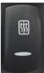
**Widerstandsschalter für das Fenster auf der Fahrerseite:** Das Fenster auf der Fahrerseite wird aktiviert, wenn die Unterkante des Schalters gedrückt wird. Sie wird deaktiviert, wenn der Schalter ein zweites Mal gedrückt wird. Wenn die Heizung nicht vom Fahrer ausgeschaltet wird, wird sie nach 20 Minuten automatisch deaktiviert.
