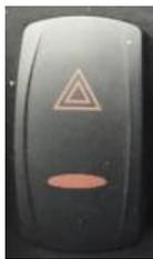
**Blinkerschalter:** Der Blinker wird geöffnet, wenn die untere Kante des Schalters gedrückt wird. Der Blinker wird geschlossen, wenn die obere Kante des Schalters gedrückt wird. Wenn der Blinker geöffnet ist, blinken die Signalwarnleuchten auf der Instrumententafel und die Funktionsleuchte am Schalter und geben zusammen mit allen Signalleuchten des Fahrzeugs ein akustisches Warnsignal ab.
