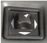
**Schalter für die Spiegelsteuerung:** Mit diesem Schalter kann der Fahrer die Richtung des Rückspiegels nach seinen Wünschen einstellen. Der Spiegel wird in die gewünschte Richtung gedreht, indem die Pfeilmarkierung auf dem Schalter in Richtung des einzustellenden Spiegels gedreht und der Schalter ausgerichtet wird (rechts, links, nach oben, nach unten).
