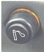
Das Feuerzeug wird in Richtung des Heizelements im Inneren geschoben und erlischt automatisch, wenn es erhitzt ist.
