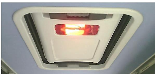
Es gibt eine Falltür für Notausstieg und Belüftung, die manuell geöffnet/geschlossen wird.
