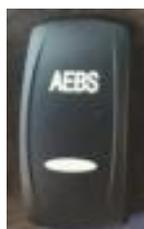
**AEBS-Schalter:** Dieser Schalter dient zur Deaktivierung des AEBS-Systems. Wenn der Schalter gedrückt wird, leuchtet die AEBS-Leuchte in der Warnblende auf. Durch erneutes Drücken des Schalters wird das AEBS-System wieder aktiviert. Die AEBS-Leuchte erscheint auch, wenn eine Störung im System vorliegt.
