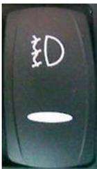
**Schalter für Nebelscheinwerfer:** Wenn der Schlüsselschalter und das Parklicht eingeschaltet sind und die untere Kante des Schalters gedrückt wird, werden die Nebelscheinwerfer aktiviert. Bei erneutem Drücken werden sie deaktiviert. Wenn der Schlüsselschalter ausgeschaltet wird, werden die Nebelscheinwerfer deaktiviert.
